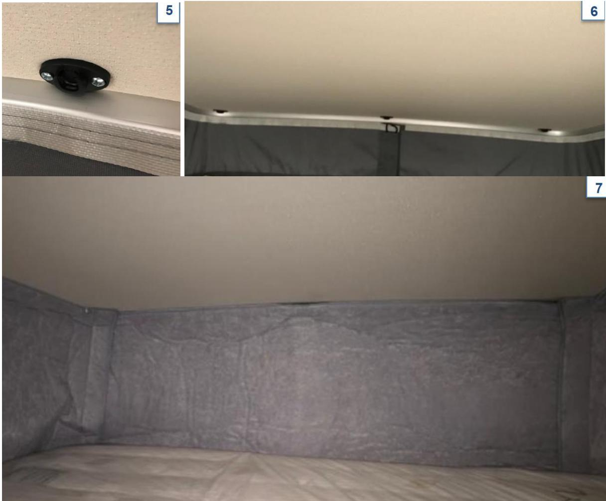
Um die Seitenteile rechts und links zu montieren, verbinden Sie zunächst das entsprechende Seitenteil mit dem Heck- und Frontteil. Montieren Sie nun ebenfalls die Magnetunterteile wie zuvor. Danach können die Seitenteile mittels der Magnete einfach angebracht werden.
