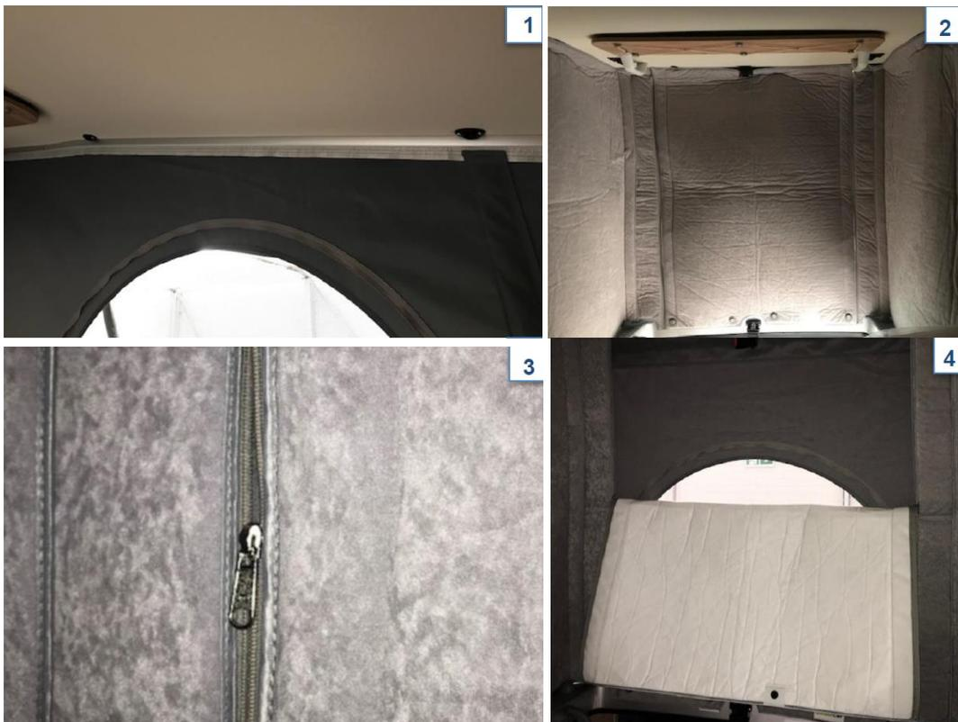
Als Nächstes folgt die Montage des Heckteils. Halten Sie hierzu die Isolierung an die Heckwand und markieren Sie sich die Positionen der Magnetunterteile. Schrauben Sie nun die Magnetunterteile unter das Dach. Die Öffnung der Magnete muss hier ebenfalls nach oben zeigen. Sobald alle drei Magnetunterteile angebracht sind, kann die Isolierung montiert werden.
