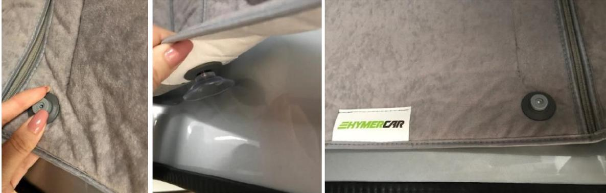
Beginnen Sie zunächst mit der Montage des Frontteils. Hierzu halten Sie das Frontteil an der Vorderwand und richten dies mittig aus. Befestigen Sie das Frontteil unten mit Hilfe der Saugnäpfe. Markieren Sie sich dann die Stellen, an denen die Unterteile der Magnete montiert werden sollen. Schrauben Sie nun die Magnete oben unter de das Dach. Die Öffnung der Magnete muss hier nach oben zeigen.
