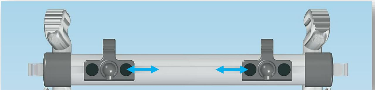
S'ils ne correspondent pas, les supports de crochets peuvent être ajustés au niveau du support de base.
