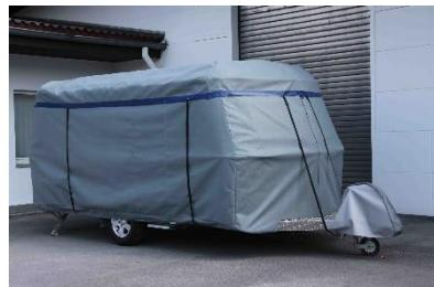
Material: SFS-3 Nonwoven-Material 160 gr/qm, atmungsaktiv, wasserabweisend, UV-stabilisiert
