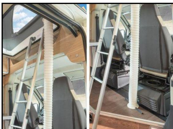
Fixer le tuyau avec les sangles de retenue dans la zone du lit intégré dans le toit et le mettre, en bas, sur les vis à l'aide des aimants.
