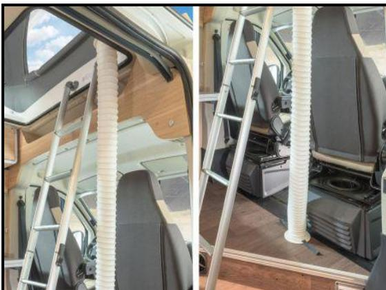
Schlauch mit den Haltebändern im Schlafdachbereich befestigen und unten mit den Magneten auf die Schrauben legen.
