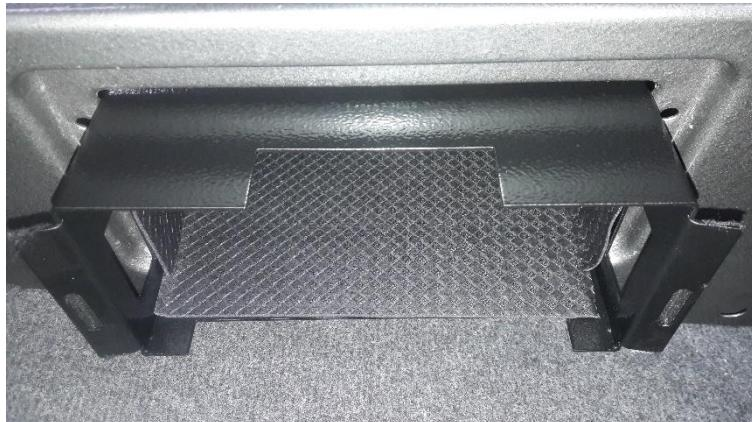
3. *Ensuite, vissez fermement le caisson à la console à l'aide des vis et des écrous fournis. Les trous sont déjà prévus à cet effet dans la console et ne doivent pas être percés séparément.*
