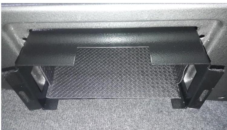
3. Anschließend verschrauben Sie den Kasten mit den mitgelieferten Schrauben und Muttern fest an der Konsole. Die Bohrungen hierfür sind bereits in der Konsole vorgesehen, und müssen nicht extra gebohrt werden.
