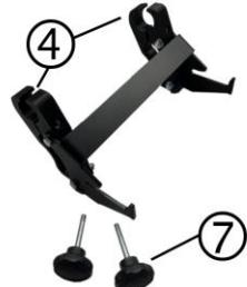
Los soportes de plástico (4) de la estructura de soporte deben colocarse alrededor de los travesaños (5) y (6).
