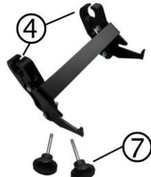
Plastikowe wsporniki (4) konstrukcji nośnej muszą być umieszczone wokół poprzeczek (5) i (6).
